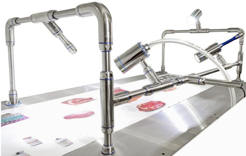
Mit dem Hygienebaukasten lassen sich Kameras, Laser und Kabel unter IP69K-Schutz installieren
