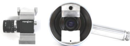
Die Kameramontage sorgt für gute Wärmeableitung
