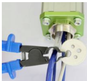
Die Sprezzange hilft beim Einführen von Kabeln in den Dichteinsatz
