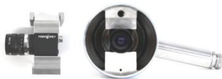
Die Kameramontage sorgt für gute Wärmeableitung
