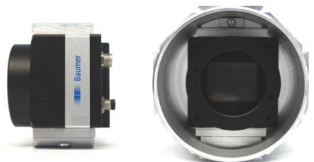
Die Montage verspricht ausgezeichnete Wärmeableitung
