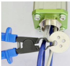
Die Sprezzange ist hilfreich zum Einführen von Kabeln in den Dichteinsatz
