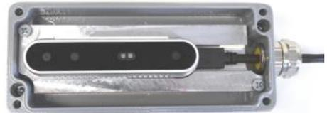
Die Montage verspricht gute Wärmeableitung
