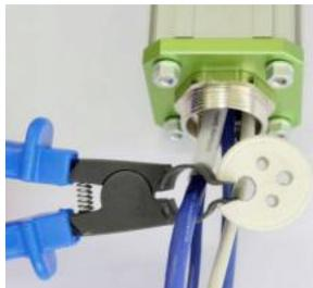
Die Sprezzange hilft beim Einführen von Kabeln in den Dichteinsatz
