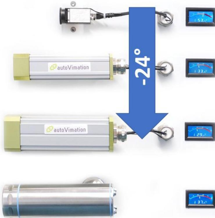
Durch die gute Wärmeableitung wirkt dabei das Außengehäuse als Kühlkörper der Kamera. Diese ist damit in der Regel statt 25-30° nur noch 5° wärmer als die Umgebungstemperatur. Hierdurch lässt sich die Kamera bei entsprechend höheren Umgebungstemperaturen einsetzen, denn üblicherweise geben die Kamerahersteller die Betriebstemperatur bis maximal 50°C Kamertemperatur an. Selbst im Dolphin Edelstahlgehäuse beträgt die passive Kühlwirkung üblicherweise noch 16°.
