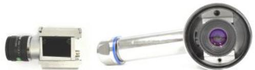
Die Kameramontage sorgt für gute Wärmeableitung
